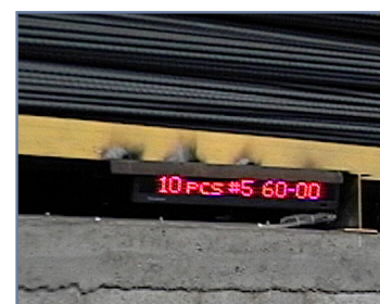
En el modo Manual, el operador puede elegir colocar una barra a la que se le ha calculado la longitud deseada de una representación en pantalla.
